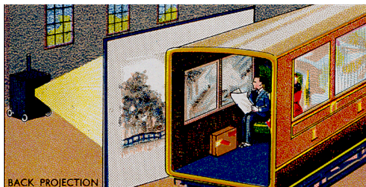
Fig. 10 - Esquema de back-projection utilizado na produção cinematográfica Fonte da imagem: http://www.isntlifeterrible.com/uploaded_images/16-back-projection-740955.jpg
