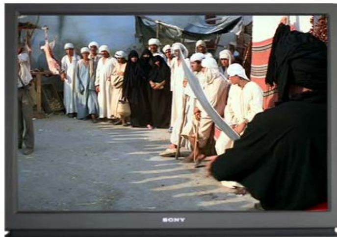
Fig. 52 - Cena 16:9 vista em tela 4:3 - Conversão Edge Crop Frame de Indiana Jones - Paramount Esquema produzido pelo autor
