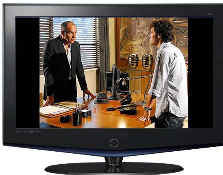
Fig. 56 - Imagem 4:3 vista no TV 16:9 configurado para 4:3 no receptor Cena da novela Escrito nas Estrelas – Rede Globo Figura produzida pelo autor
