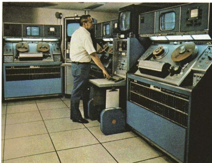
Fig. 11 - Ilha de edição quadruplex com 3 máquinas Fonte da imagem: Video Tape Post-Production - Revista RCA Broadcast News
