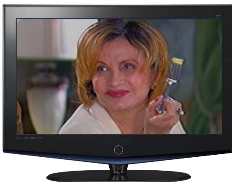
Fig. 61 - Cena 4:3 vista no 16:9 - Conversão Crop - close forçado Figura produzida pelo autor
