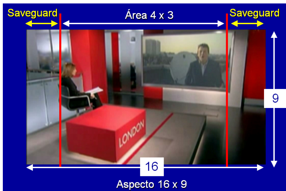
Fig. 54 - Saveguard da área 4:3 em um captação em 16:9 Cena do telejornal BBC News – BBC Londres Esquema produzido pelo autor
