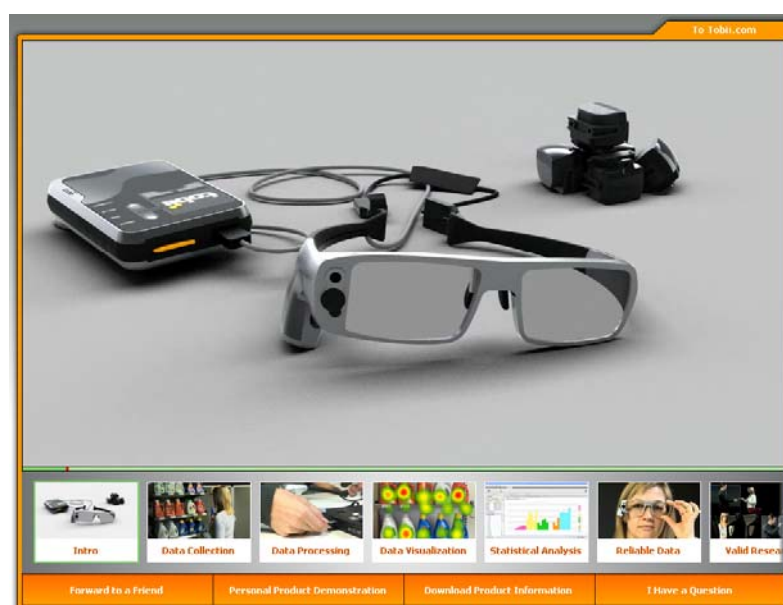
Fig. 80 - Óculos Tobii-glass - dispositivo para registrar onde os olhos estão olhando Divulgação Tobii
