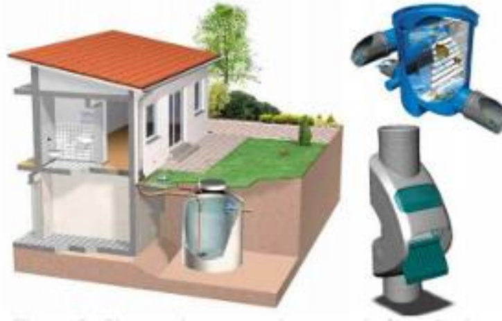
Figura 19 – Sistema de Aproveitamento de Chuva
