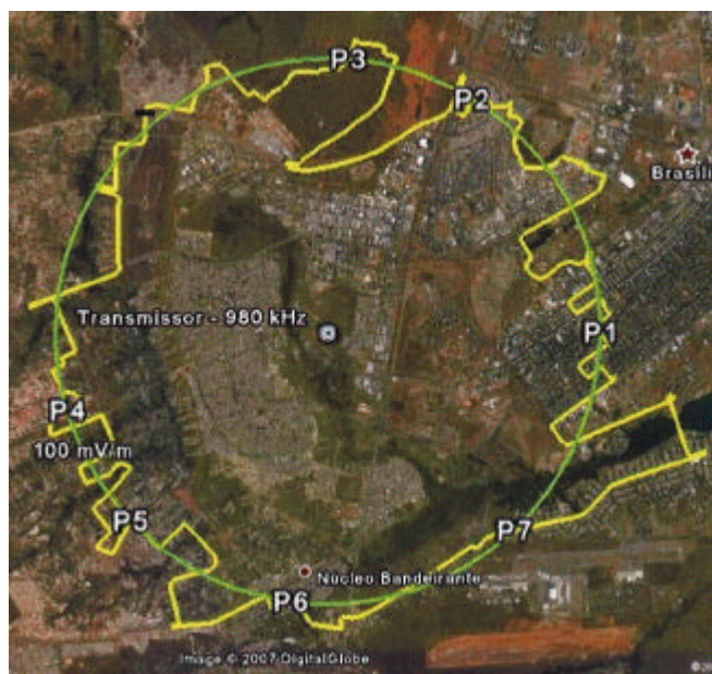
Mapa 4 – Exemplo de uma rota circular (traços amarelos) utilizada nos testes da UnB que segue aproximadamente a linha de intensidade de campo de 100 mV/m (linha verde), tendo como centro o parque emissor da Radiobrás.
