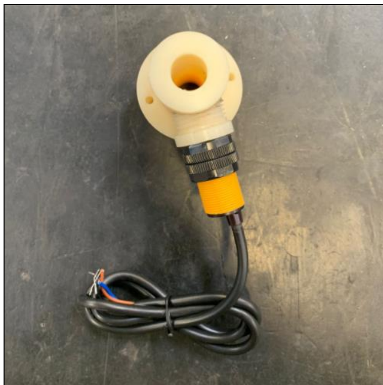
Figura 38 – Vista inferior do sensor Infravermelho e funil de escoamento
