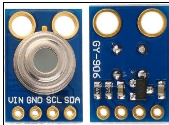
Figura 8 – Sensor de temperatura Infravermelho IR MLX90614
