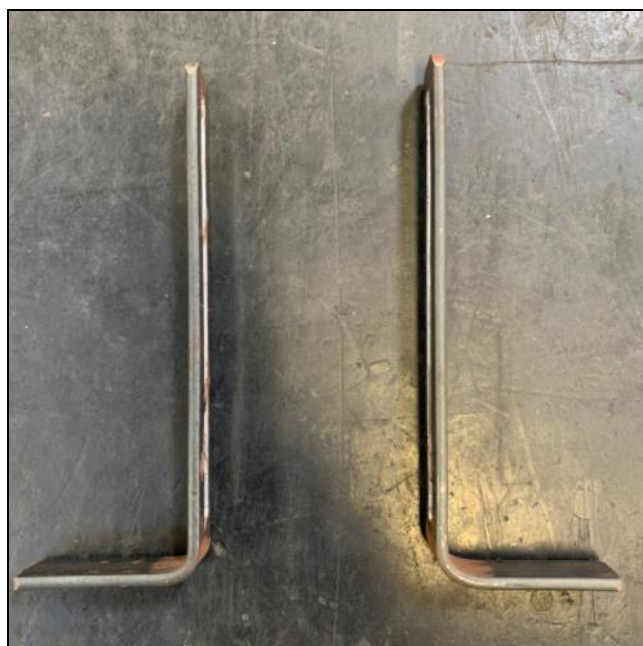
Figura 41 – Suportes para fixação dos discos
