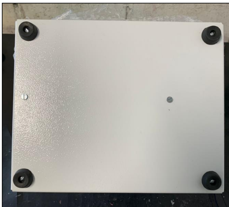
Figura 47 – Pés fixados na base da estrutura externa
