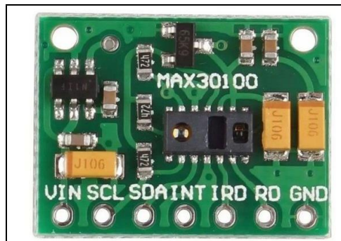
Figura 10 – Sensor Oxímetro e de Batimentos Cardíacos MAX30100
